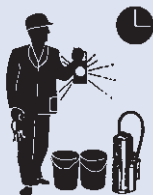
Bild 4: „Schutzmaßnahmen bei Schweiß- und Schneidarbeiten“ aus „Richtlinie für den Brandschutz bei Schweiß-, Löt- und Trennschleifarbeiten“ vom Verband der Schadensversicherer
